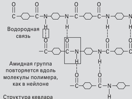
вдоль всей длины каждой цепочки, такие связи создают упорядоченную и очень крепкую сетку. Есть, впрочем, один минус: эта структура придает материалу минимальную гибкость, и потому такой бронезильт спасет вам жизнь, однако носить его неудобно.
